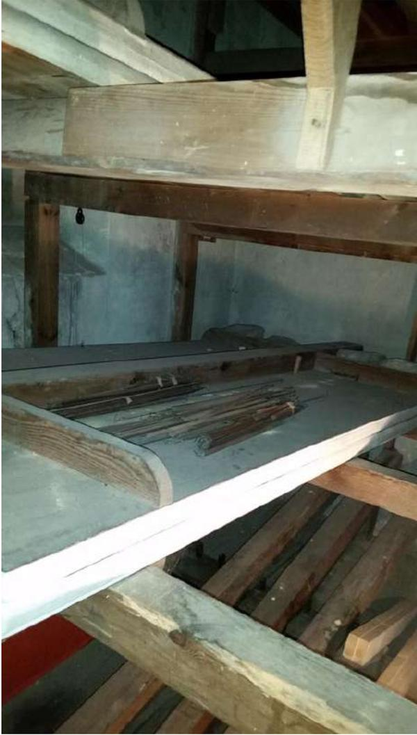
Der alte Blasebalg (links) wurde nach der Belederung an das Windsystem der Orgel angeschlossen. Die neue Windanlage (unten) leitet die Luft aus dem Blasebalg in die Windladen der Orgel.
